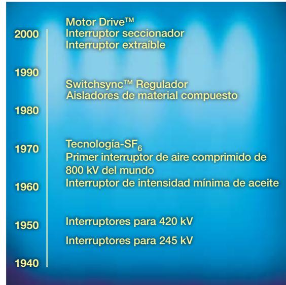
*Hitos en los adelantos de ABB en interruptores de alta tensión.*
